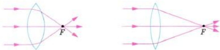
Рис. 155. Преломление лучей линзами различной кривизны
